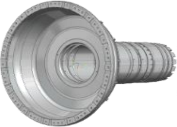
Fan Shaft Plant 3
